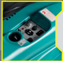
I comandi sono semplici ed ergonomici. Un solo pedale controlla la marcia avanti e retromarcia. Le leve per abbassare o sollevare la spazzola centrale e quelle laterali sono poste sul pannello di controllo così come lo scuotifiltro elettrico e il pulsante per il blocco aspirazione che agevola la pulizia di superfici umide.
