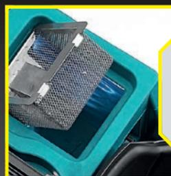
IL SERBATOIO DI RECUPERO è dotato di un cesto standard in acciaio inox per evitare il passaggio di detriti voluminosi che potrebbero ostruire il sistema.
