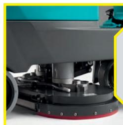
LA TESTATA SPAZZOLE è dotata di un paraspruzzi autoregolabile che, oltre ad impedire gli spruzzi di acqua sporca durante il lavaggio del pavimento, permette di evitare le perdite d'acqua.
