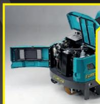
Tutti gli organi meccanici interni sono facilmente accessibili per le operazioni di manutenzione, poiché i pannelli posteriori, laterali e superiori si possono aprire completamente. Le batterie (Versione EB) possono essere sostituite facilmente e rapidamente grazie a rulli di scorrimento posti sul fondo del contenitore.
