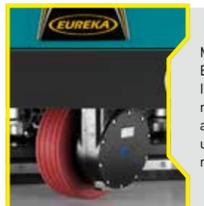
**MOTORE TRAZIONE PROTETTO DA URTI E UMIDITÀ**
