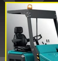
Il tettuccio di protezione in acciaio ricopre l'intera postazione di guida. Pone l'operatore al riparo da possibili cadute di oggetti dall'alto.
