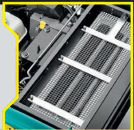
La versione a batteria vanta una maggiore autonomia per una produttività superiore. La manutenzione è di per sé estremamente semplice e il cofano della macchina si solleva completamente per permettere l'accesso al compartimento batterie, al vano motore o ad altri organi che possano necessitare di assistenza.
