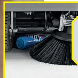
La carena in acciaio avvolge il corpo delle macchine, mentre speciali lastre di rinforzo ricoprono il blocco delle spazzole laterali.
